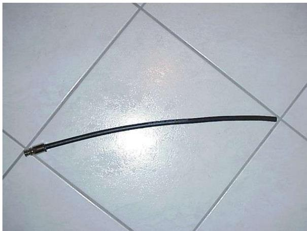
Ici un tronçon de RG-213 avec connecteur BNC sur mon carrelage pour la photo!
